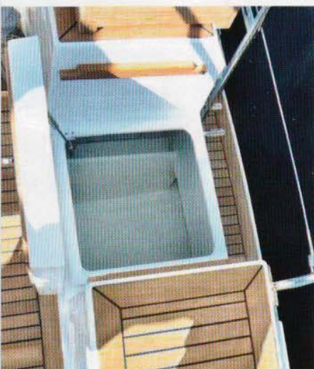
Luckan i aktern ska rymma flotten och ger enkel passage till den inbyggda badbryggan.
