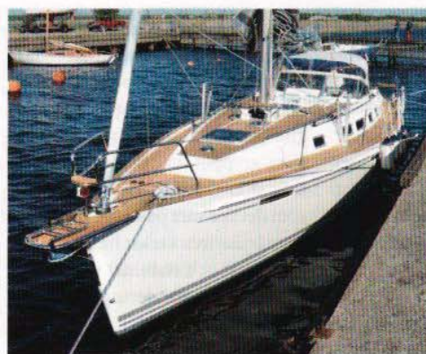
Troget långsfärdsidalet är friborden höga, men för fart är stäven smal och djup.
